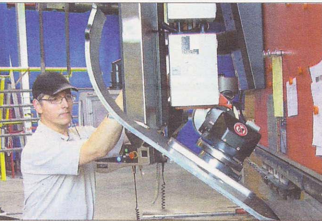
Handhabungsgerät Posimat PB 160 dient zur Beschickung einer Biege-
